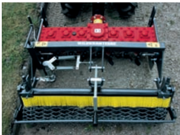
randscharfes Arbeiten mit Seitenmesser und autom. Fremdkörpersicherung
