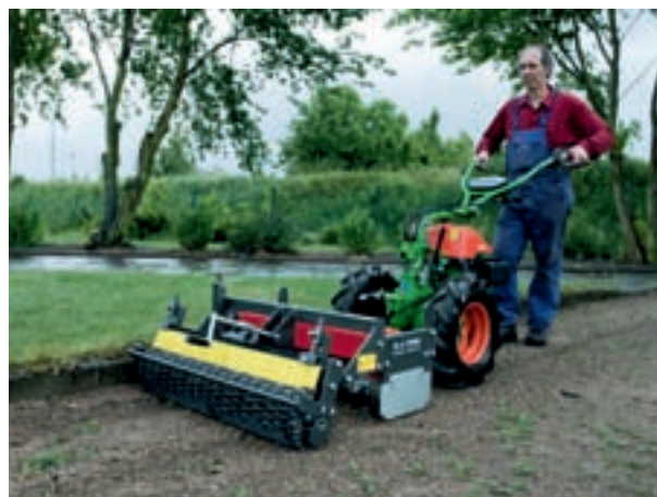
optimale Reinigung der Gitterwalze durch einstellbaren Bürstenabstreifer
